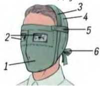
Рис. 2 — Устройство противопыльной тканевой маски
